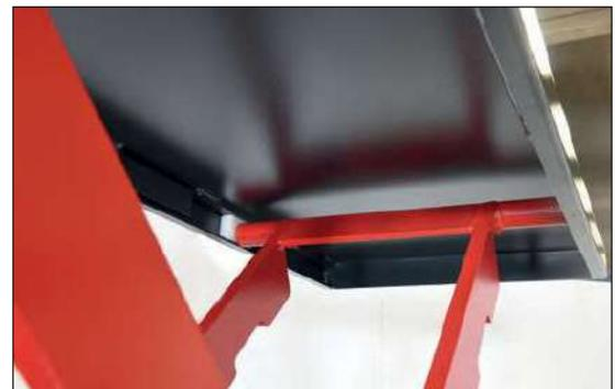
**IT Pattini di scorrimento inferiore e superiore in materiale plastico autolubrificanti.**
